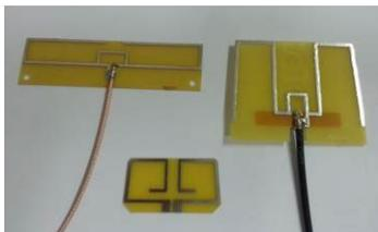
Linear polarisierte OEM Antennen zur Integration in mobile Geräte und Drucker
