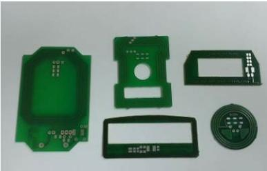
Zu den Micro Engine Decodern Pin kompatible Add On Boards und Antennen mit Abstimmnetzwerk
